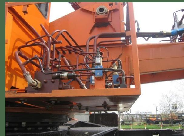
ДЗАК (Украина) – первоначальное создание распределителя и клапанной аппаратуры с переходом к комплекту с пропорциональным управлением
