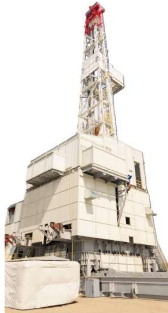
❑ Буровая установка 1500 HP эшелонного типа
