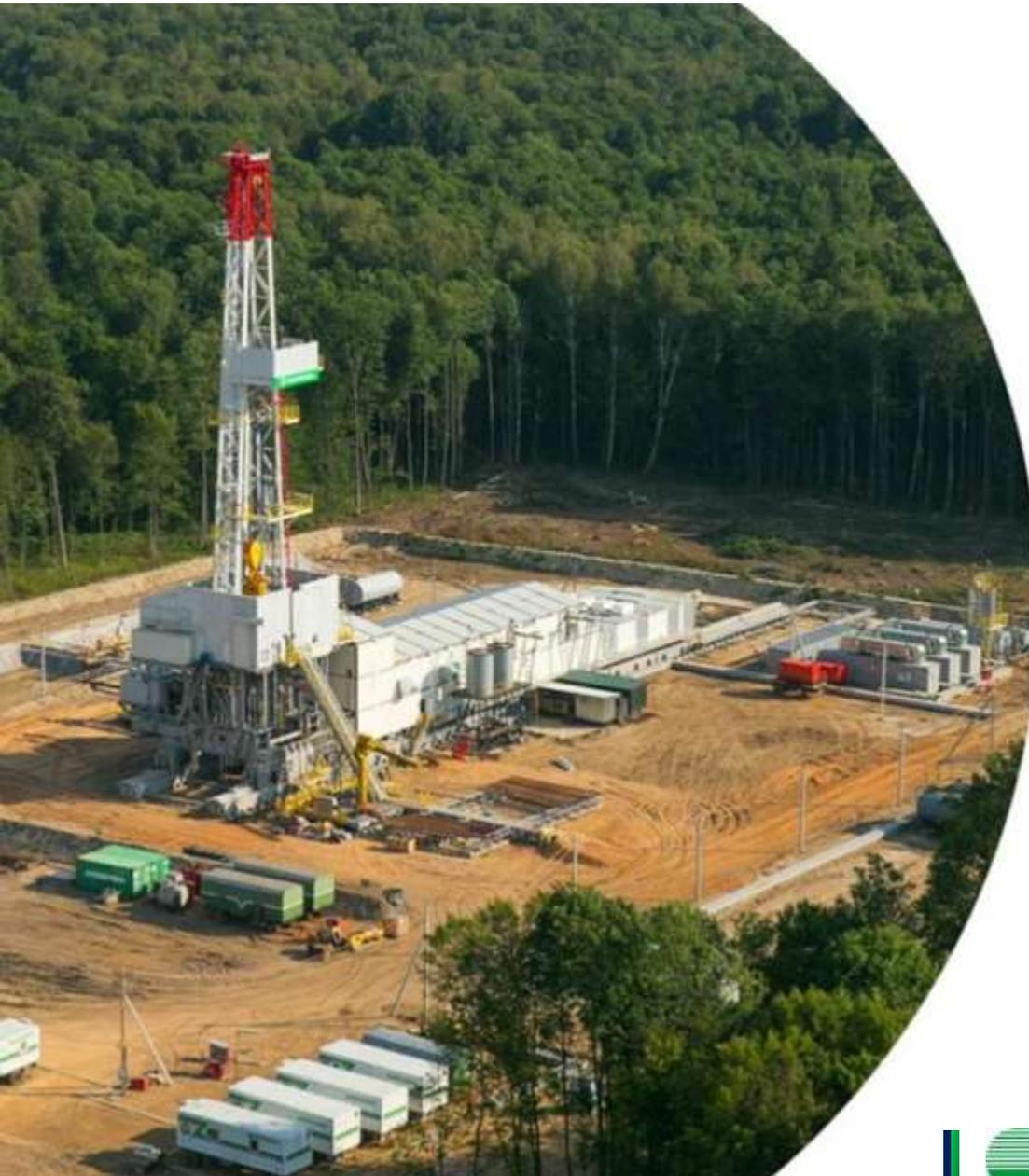
Буровая установка эшелонного исполнения г/п 345 т предназначена для проведения буровых работ при разработке и строительстве нефтяных скважин. Включает в себя мачтовую вышку, размещаемую на подвышечном основании, на котором также расположены лебедка буровая мощностью 1500 л.с., пульт управления бурильщика и другое вспомогательное оборудование для осуществления спуско-подъемных работ и непосредственно процесса бурения.
