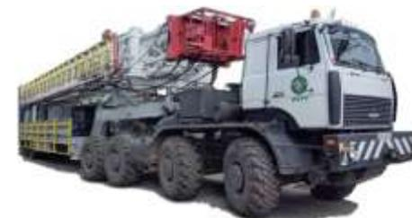
□ APC-250 с частотно-регулируемым приводом
