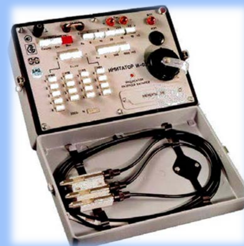
ИМИТАТОР ЭЛЕКТРОДНОЙ СИСТЕМЫ И-02
