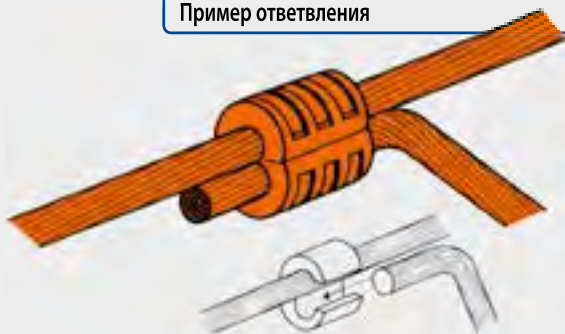
Пример соединения двух токоведущих жил
