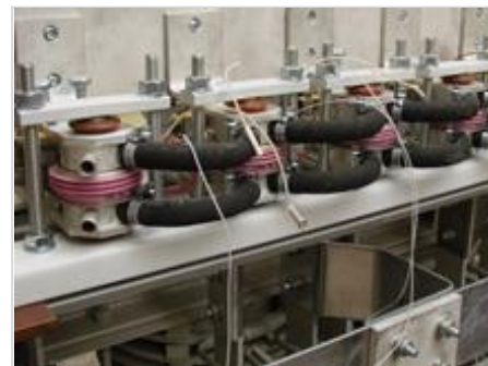
с водяным охлаждением тиристоров от 800А до 12 500А
