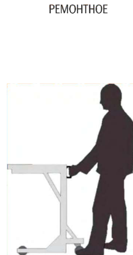
КВЭ находится вне корпуса шкафа и главные и вспомогательные цепи разомкнуты
